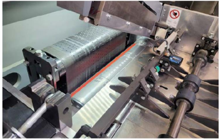
マグネットシリンダーとフィルム用ナイフによる完全カット。垂直バキューム搬送部
